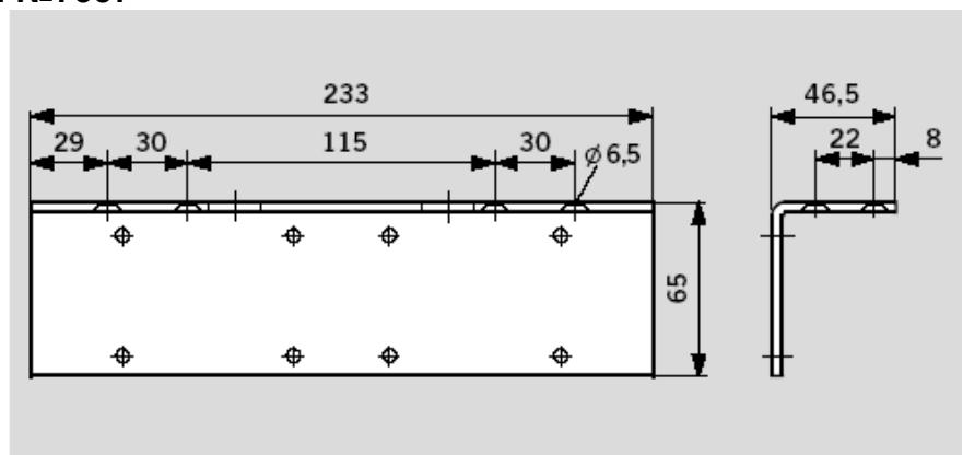
Предназначен для установки доводчика в дверной проём на раму.
