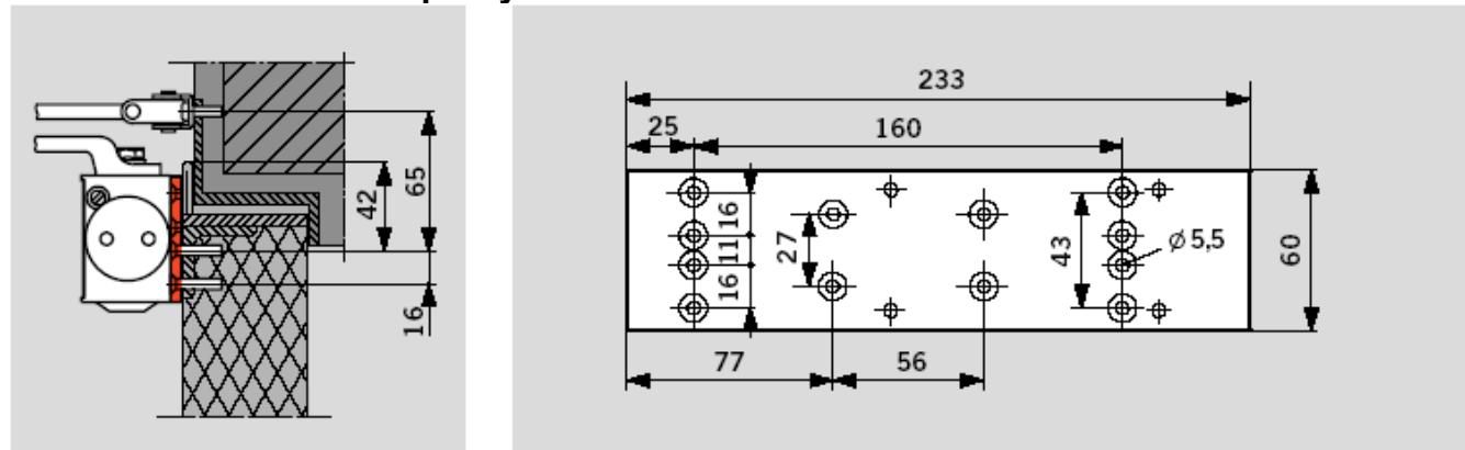
Предназначена для случаев, когда непосредственный монтаж невозможен и для противопожарных дверей. Группа отверстий выполнена согласно стандарту EN1154, приложение 1.
