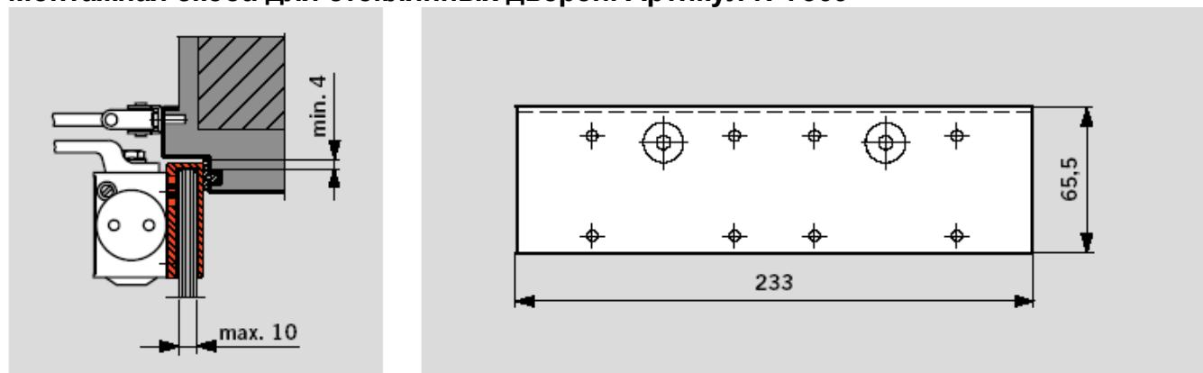
Предназначена для монтажа на цельностеклянные двери толщиной 8-10мм.
