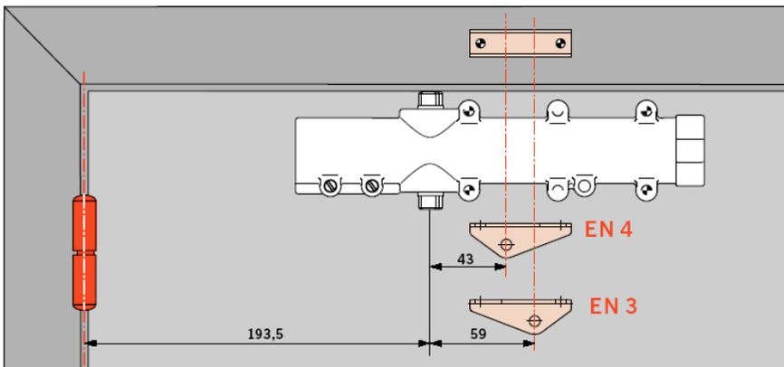
EN3 – ширина дверного полотна  $\leq 950$ мм
